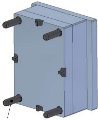
Hauptführung für die Grobausrichtung beim Schliessen und bei der Montage
